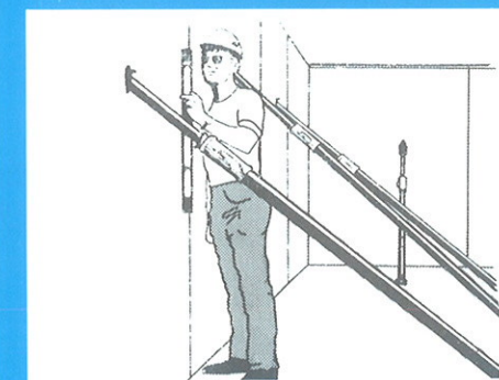
3. Væggene afstives ved hjælp af skræstøtter. Nødvendig fugearmering anbringes før eller efter montagen. Væggene er nu klar til udstøbning af den resterende beton.
